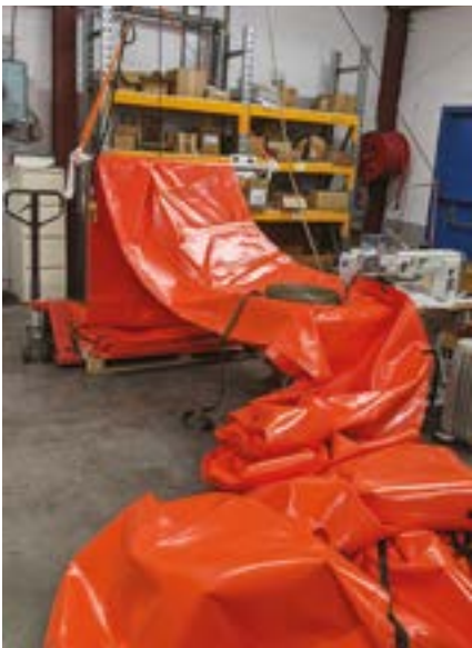
Fabrication d'un barrage de 50 mètres
